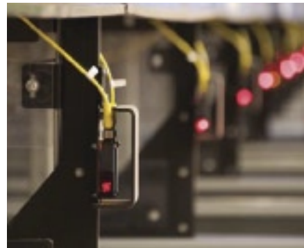
Der Entwurf der BGN sieht eine Absicherung des Catwalks vor, Lichtschranken an der Vorderseite der Bahnen schützen vor unbefugten Eingriffen. Alternative Lösungen sind auch hier möglich.
